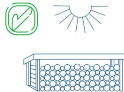
Las bajas temperaturas por debajo de 4 °C determinarán precauciones especiales en la manipulación de los tubos.
