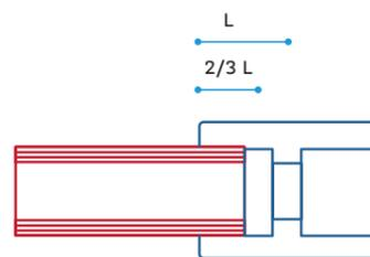
Figura 6. Termofusión a socket.
